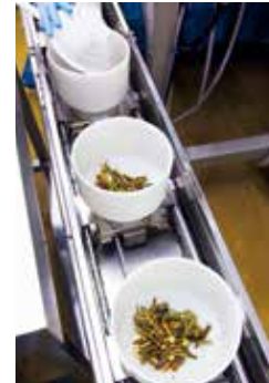
100gずつ容器に移し、コンベアでパッキング工程へ運びます
