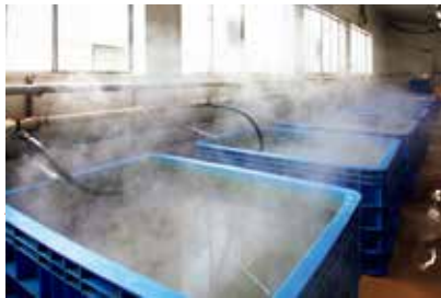
100度の湯で塩分0%まで塩抜きします
