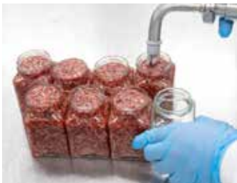
充填機のノズルから瓶に梅なめ茸を入れます
