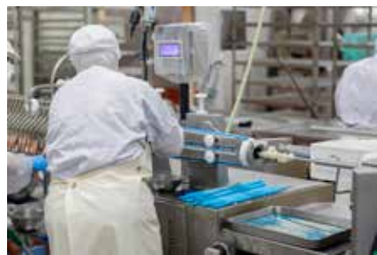
右端の細い金属ノズルにセットされているのが天然羊腸。味付けした挽き肉を充填します
