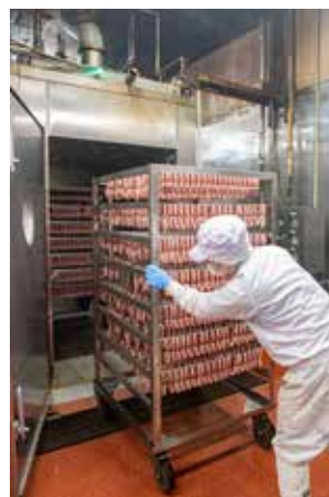
スモーク装置で熟成・乾燥・スモーク・ボイルを行います
