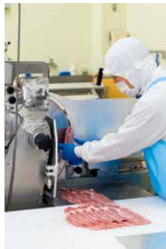
円盤の刃が動いて塊肉を薄切りにしていきます
