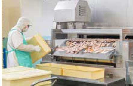
トンネルフリーザーにぶりを投入し、凍結させます
