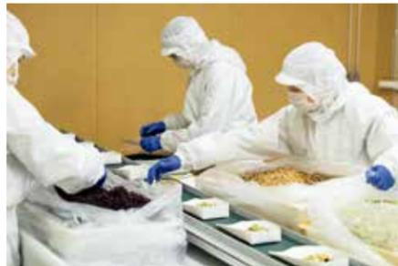
コンベアで流れてくるトレイに、乾燥わかめ、乾燥ふのり、乾燥ねぎ、巻麩を計量しながら乗せていく
