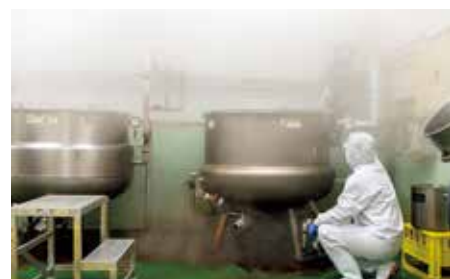
二重構造の釜下部の膨らみ部分に蒸気を通し、加熱
