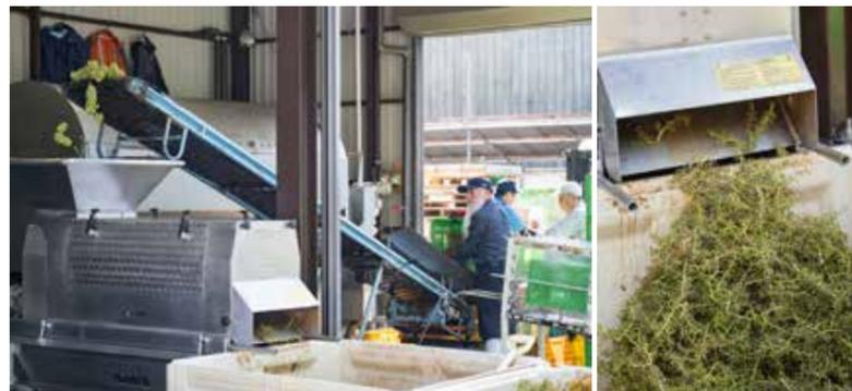
ぶどうは除梗破砕機に投入され、取り除かれた軸が排出されます
