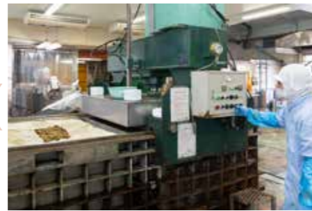
プレス工程。金属板で圧搾すると、側面の穴から水が浸み出す
