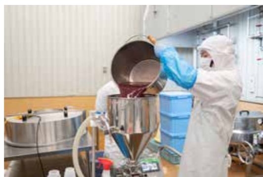
加熱が終わったソースは、50℃程度まで冷ました後、充填機へ
