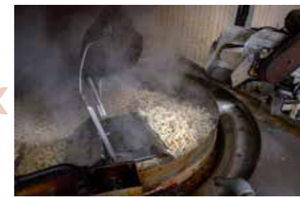
米油が入った大きな釜に投入。金属羽で攪拌しながら揚げていく
