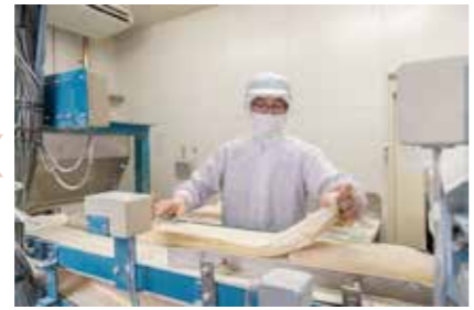
発酵した生地を圧延機にかけ、食べやすい厚さにのばしていく
