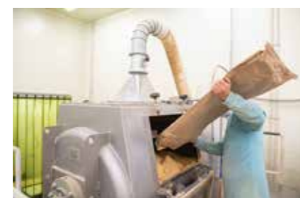
きな粉にアーモンドと黒ごまのパウダーを加え、攪拌する(くるみ黒糖こんがりきな粉も同様に製造)
