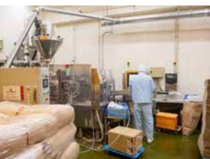
パッケージへのきな粉充填後、機械と目視による検査をして箱詰めとなる
