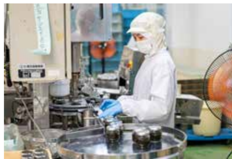
蓋がしっかり閉まっているか、閉まり過ぎているか、目視で確認
