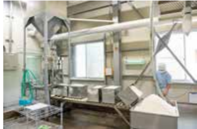
洗米後水切りしたもち米をホースで吸い上げ阿部製粉機に送る
