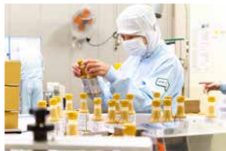
最終工程の目視による検査。中身、ラベルの位置や表示内容が間違っていないかなどを確認します
