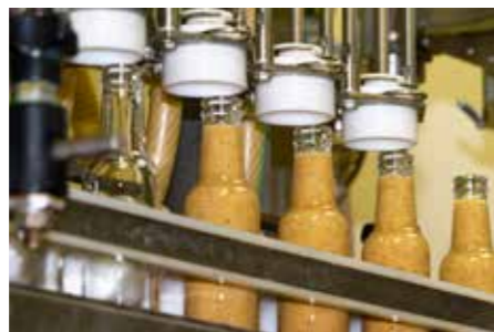
充填工程。ドレッシングを調合釜から瓶に注入し、蓋をする工程に進んでいきます
