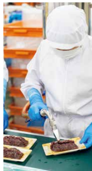
デポジッター(充填機)を使い、蒸米(1個約40g×2)を餡(1パック約120g)で覆います
