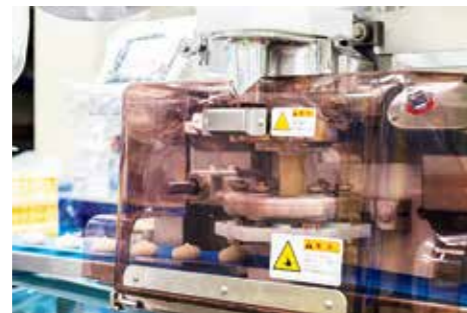
「どっしりおはぎ」専用の機械。蒸米をつぶさずに、粒を残したまま成形します
