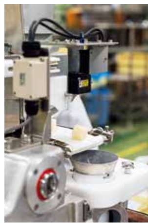
機械に投入された蒸米は、決められた分量ごとに切り分けられ、パネ軸をつたって下りていきます
