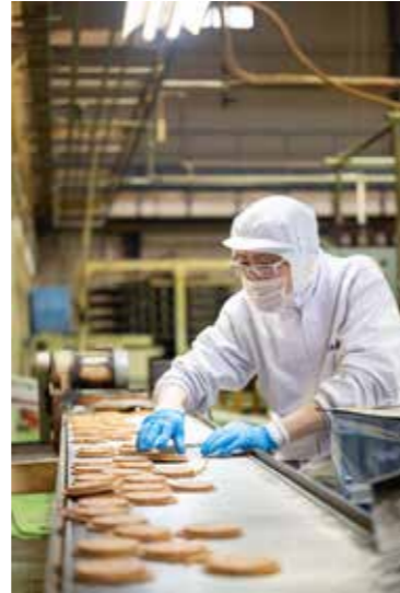
型からあふれ出したせんべいの「耳」と呼ばれる部分を、おおよそ同じ大きさになるようにカット。次の工程に行く前に目視で検品を行います
