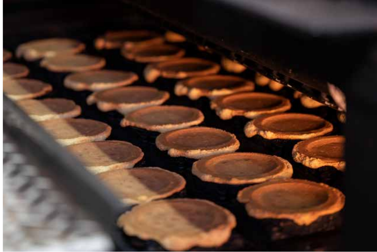
美しい焼き色の「香ばしピーナッツ厚焼せんべい」。一度の仕込みで生地は50キロ。およそ2700～2800枚分にあたり、30分弱でそのすべてが型に流されていきます
