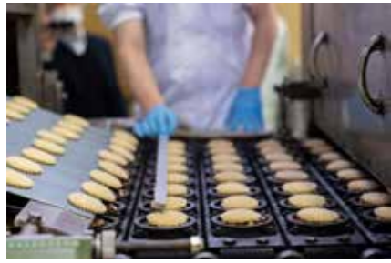
先にピーナッツを型に落とし、生地を上のにせてオープンへ。約180度で10分ほどかけてじっくり焼いていきます
