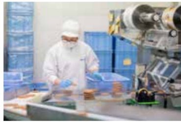
30分から40分かけて放冷し、熱を逃がしたあと、一枚一枚個包装に
