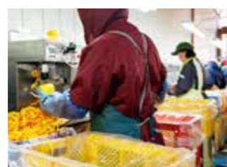
処理機を活用し、必要なところはピーラーを使って手作業も交えながら皮を剥いていきます
