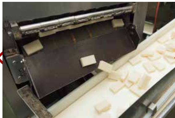
成型されたお餅。スリットを入れ、2段階で切断していきます
